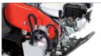
Distributore a leva per comando ribaltamento idraulico.
