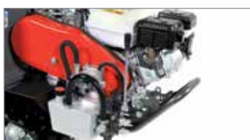
Distributore a leva per comando ribaltamento idraulico.
