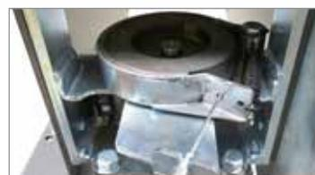
Il freno di servizio e di stazionamento si inserisce automaticamente al disinnesto della frizione, prevenendo movimenti accidentali pericolosi.
