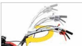
Stegole regolabili orizzontalmente e verticalmente, permettono all'operatore di lavorare con una postura corretta.
