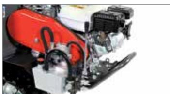
Distributore a leva per comando ribaltamento idraulico.
