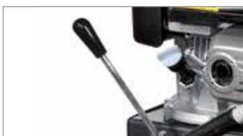
Comando selettore delle velocità con leva.
