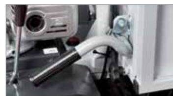
Ribaltamento manuale con sistema di bloccaggio automatico.
