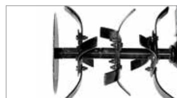
Fresa a tre elementi per lato da 82 cm con dischi laterali di protezione.
