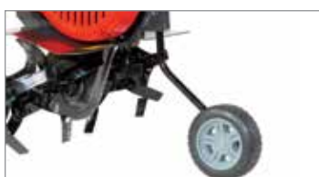
Ruota di trasferimento posteriore utile per lo spostamento della macchina.
