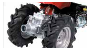
Attacco rapido QuickFit integrato che consente all'operatore di cambiare le attrezzature senza l'utilizzo di chiavi.
