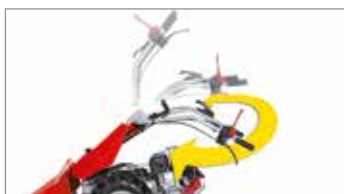
Stegole orientabili verticalmente e orizzontalmente con dispositivo antivibrante per un maggiore comfort di utilizzo.
