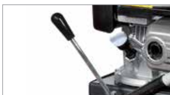
Comando selettore delle velocità con leva.
