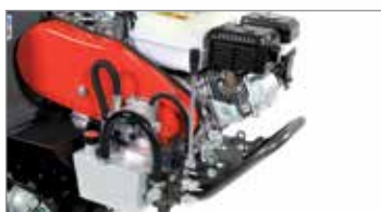
Distributore a leva per comando ribaltamento idraulico.
