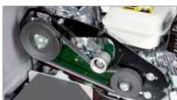
Frizione a cinghia, con disinnesto automatico al rilascio della leva di comando.
