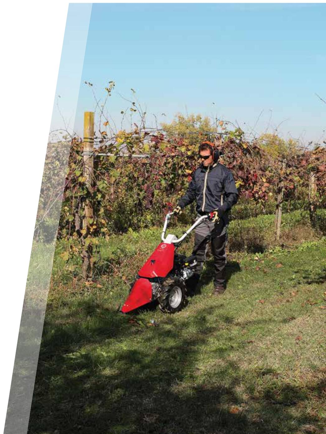
\* QuickFit: sistema di attacco rapido che consente all'operatore di cambiare le attrezzature (barre falcianti, frese, ...) senza l'utilizzo delle chiavi
