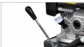
Comando selettore delle velocità con leva.
