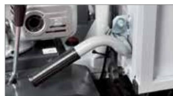
Ribaltamento manuale con sistema di bloccaggio automatico.
