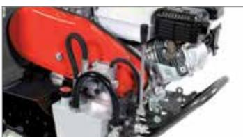
Distributore a leva per comando ribaltamento idraulico.
