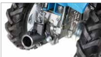
Attacco rapido QuickFit integrato che consente all'operatore di cambiare le attrezzature senza l'utilizzo di chiavi.
