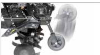
Ruota di trasferimento anteriore utile per il trasporto della macchina. È facilmente ribaltabile in altezza senza attrezzi per agevolare il lavoro sul terreno.
