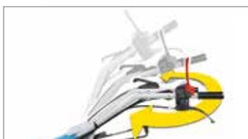
Stegole orientabili verticalmente e orizzontalmente, reversibili a 180°, con dispositivo antivibrante per un maggiore confort di utilizzo.
