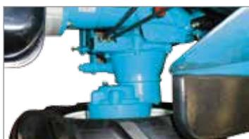
Frizioni di sterzo a comando combinato con i freni, permettono di ruotare la macchina di 360°, con un minimo raggio di sterzata.
