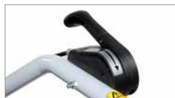
Pratico inversore di marcia, che permette di passare velocemente alla retromarcia da qualsiasi velocità: rende la macchina maneggevole durante le varie attività di lavoro.
